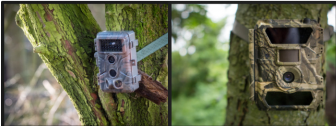
Black-LED's sind Low-Glow LED's mit einem schwarzen Glas (rechtes Bild), welches die Wildkamera etwas unauffälliger macht. Mittlerweile sind fast alle Geräte mit schwarzem Glas ausgestattet (teilweise auch nur mit der Bezeichnung No-Glow-LED's)
